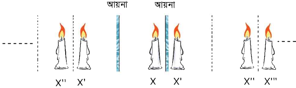
চিত্র 8.04: দুটি সমান্তরাল আয়নার মাঝখানে একটি মোমবাতি x রাখা হলে তার প্রতিবিম্ব x' এবং x' প্রতিবিম্বের প্রতিবিম্ব x'' , x''' ... তৈরি হতে থাকে।
