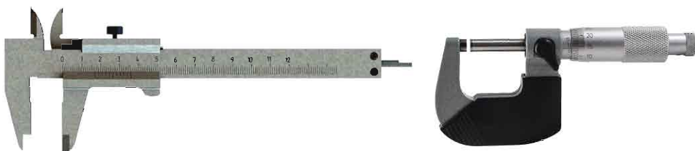
চিত্র 1.07: চিত্রটিতে ভার্নিয়ার স্কেলযুক্ত স্লাইড ক্যালিপার্স এবং একটি স্কুগজ দেখানো হলো।
